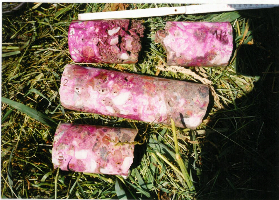
Rys. 4. Badanie zasięgu karbonizacji na wyciętych próbkach rdzeniowych.
